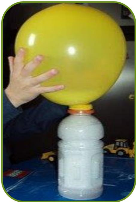
**Explication:** une réaction chimique se produit entre le vinaigre et le bicarbonate de soude qui produit du  $\text{CO}_2$ . Comme tous les gaz, le dioxyde de carbone se dilate également en gonflant le ballon pour occuper l'espace à l'intérieur.
