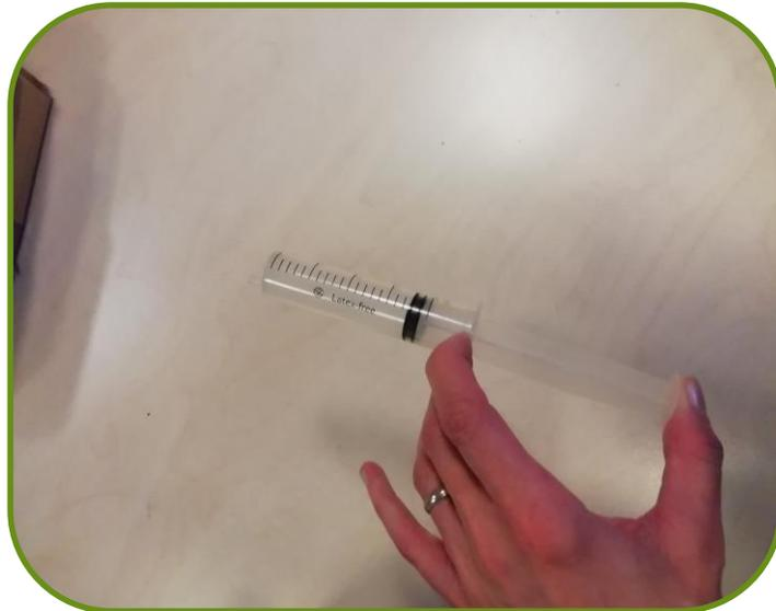
**Explication:** l'air est élastique, compressible et prend de la place. En faisant le même test avec de l'eau, le piston ne bouge pas: l'eau n'est pas compressible.
