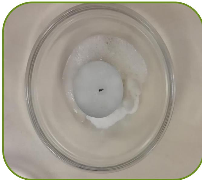
**Explication:** une réaction chimique se produit entre le bicarbonate de soude et le vinaigre avec formation de  $\text{CO}_2$  qui provoque l'extinction de la flamme.
