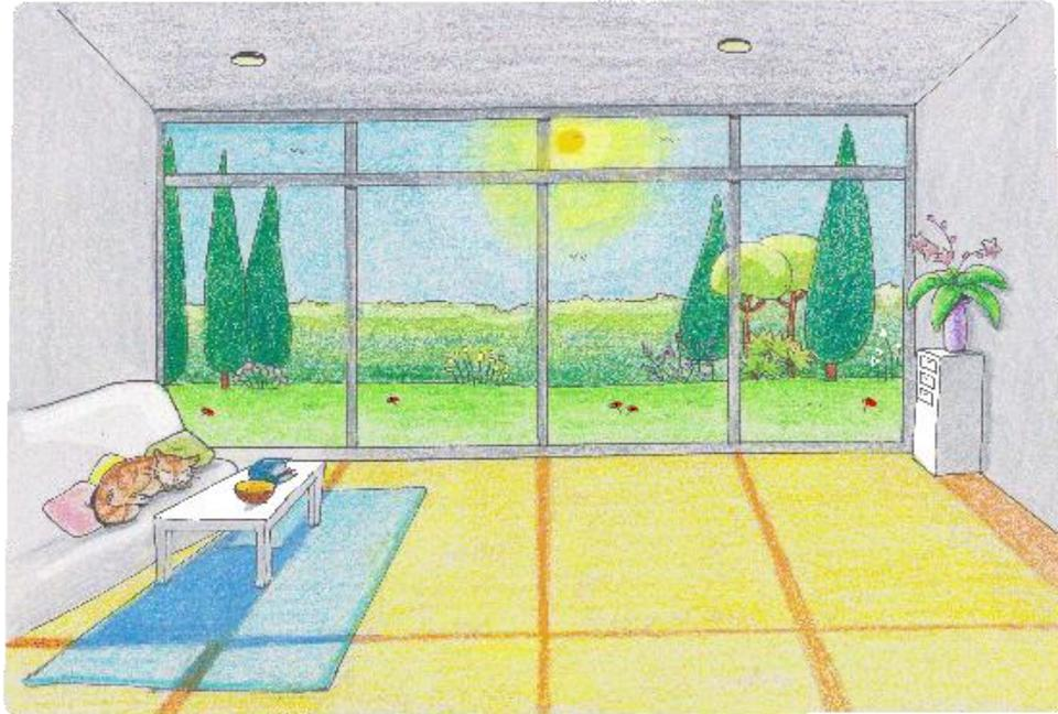
**L'énergie solaire passive** est l'énergie captée à l'intérieur des pièces par les fenêtres ou les baies vitrées pour l'éclairage naturel et le chauffage (les murs, planchers et meubles absorbent l'énergie solaire et la diffusent ensuite sous forme de chaleur).
